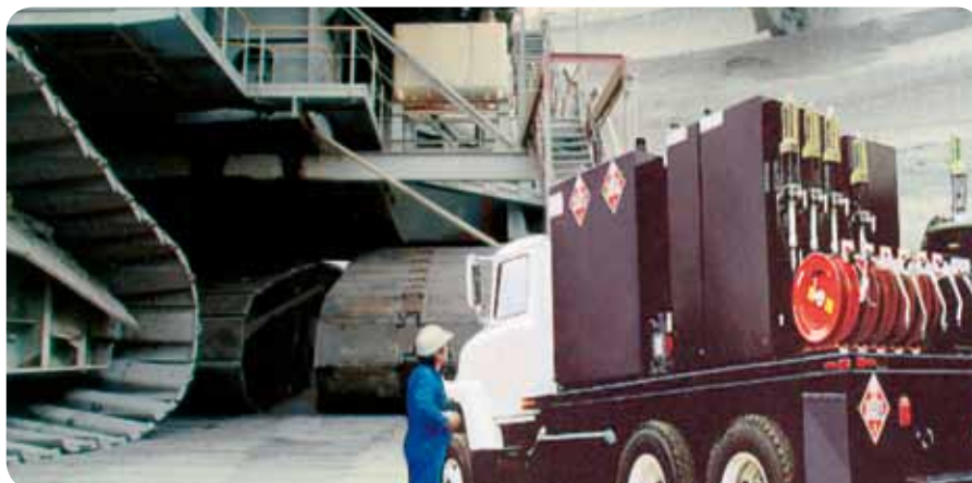
Lubrovan сервисный смазочный агрегат с гидравлическим насосом Power-Master III
