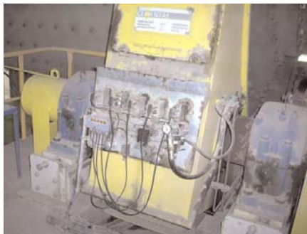
ЦСС фирмы Lincoln с применением смазки Mollus 205 фирмы Shell
