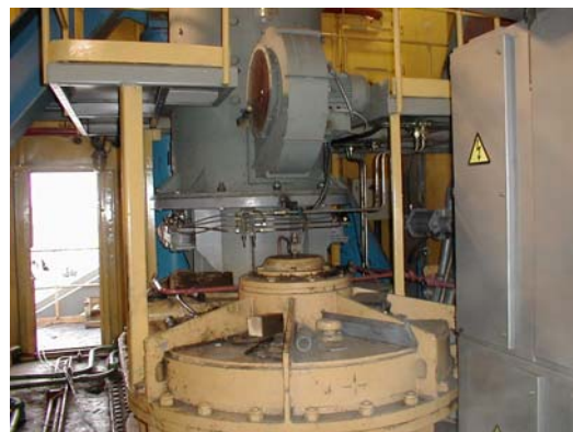
Размещение распределителя смазки на приводе поворота платформы
