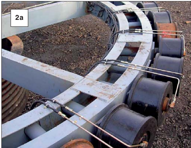
Фото 2 Установка элементов АЦСС на экскаваторе ЭКГ-10: а) на монтажной площадке экскаватора у заказчика; б) на заводе-изготовителе
