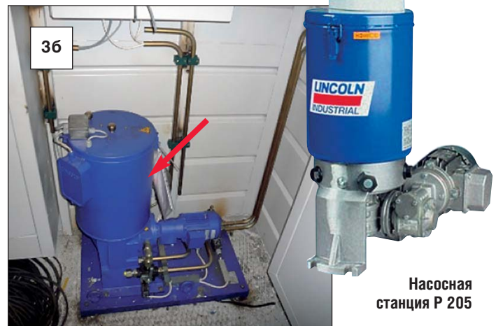
Фото 2 Установка элементов АЦСС на экскаваторе ЭКГ-10: а) на монтажной площадке экскаватора у заказчика; б) на заводе-изготовителе
