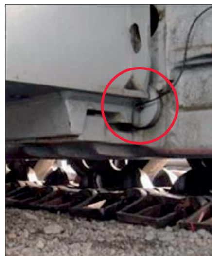
Фото 1 Первоначальный вариант установки ЦСС на экскаваторе ЭКГ-10
