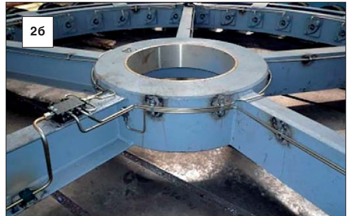
Фото 2 Установка элементов АЦСС на экскаваторе ЭКГ-10: а) на монтажной площадке экскаватора у заказчика; б) на заводе-изготовителе
