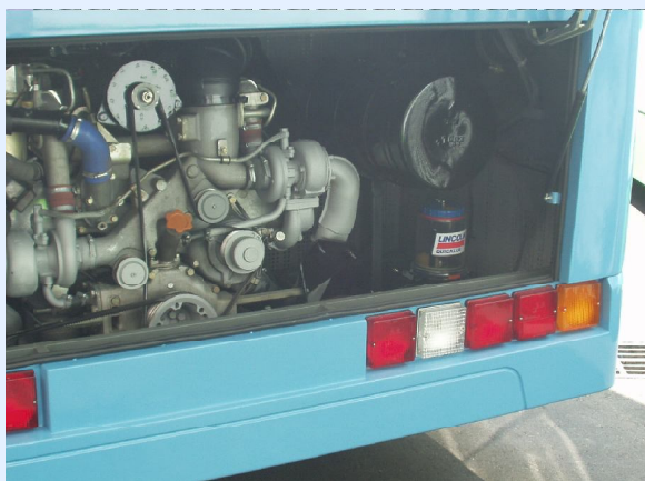
Пример установки насоса на автобусе
