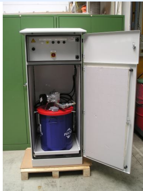
Насосная станция в шкафу
