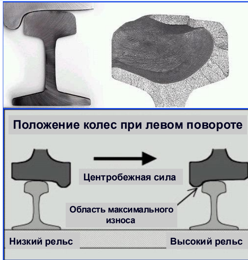
Рис 4.1. Взаимодействие колеса и рельса при левом повороте
