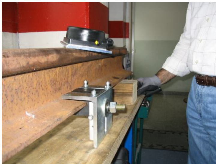
Установка крепления сенсорного датчика
