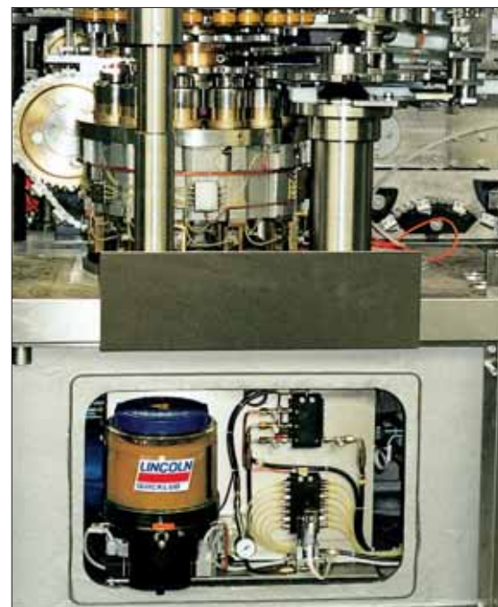
Разливочная машина с прогрессивной системой Quicklub
